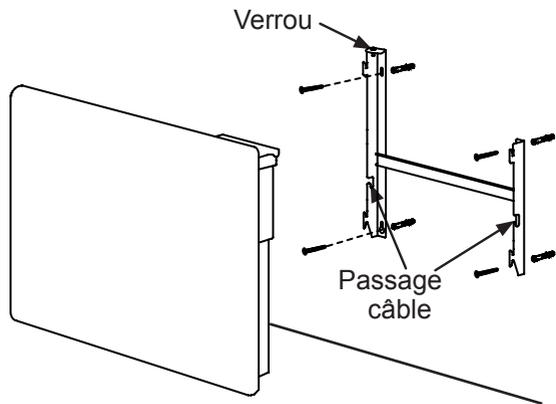
Les vis et chevilles fournies sont adaptées pour des supports de type plein. Pour tout autre type de support, veuillez utiliser les vis et chevilles adaptées.
