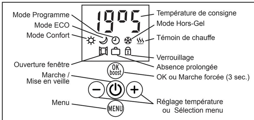
*L'icône et la valeur en cours de réglage clignotent. Le clignotement s'arrête quand le réglage est validé par la touche **OK-boost**, ou après 30 secondes d'inaction (la modification du réglage est alors annulée).*
